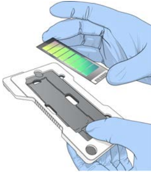
řekil 19 BeadChip'i Adaptöre Yükleme
