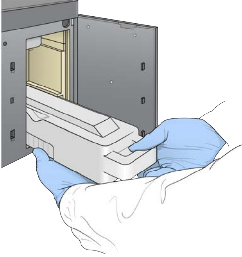
Őekil 14 Kullanılmıř Reaktif Kabını ıkarma
