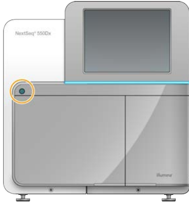
Şekil 9 Cihazın Önünde Yer Alan Güç Anahtarı
