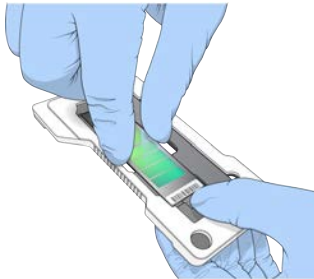
řekil 20 BeadChip'i Oturtma ve Sabitleme
