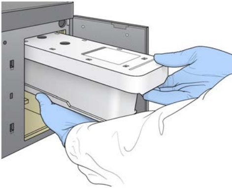
Figura 16 Caricamento della cartuccia di tamponi
