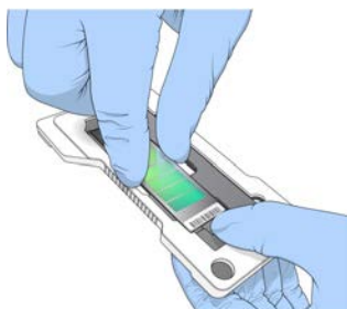
Abbildung 21 Einsetzen und Befestigen des BeadChips
