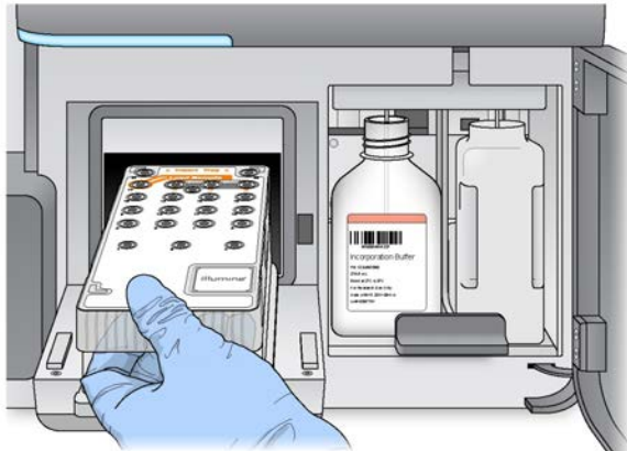
Figure 21 Charger la cartouche de réactifs
