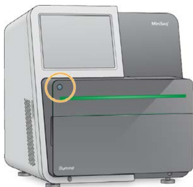
圖 8 電源按鈕位於儀器正面
