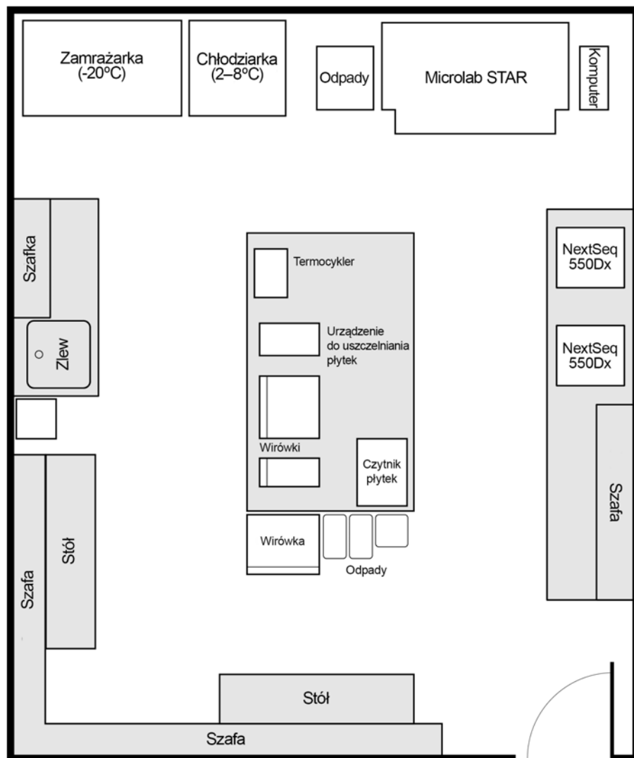
Rysunek 1 Przykładowe rozmieszczenie systemu VeriSeq NIPT Solution v2 w laboratorium (nie w skali)
